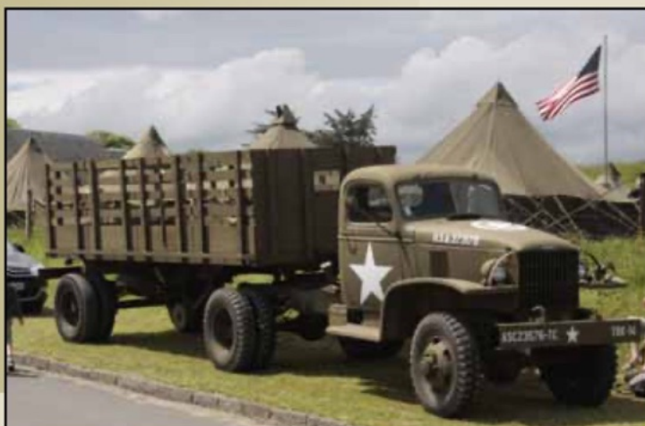
▲ Een Chevrolet, 1,5 ton 4x4, trekker met een enkel-as stake cargo trailer.
